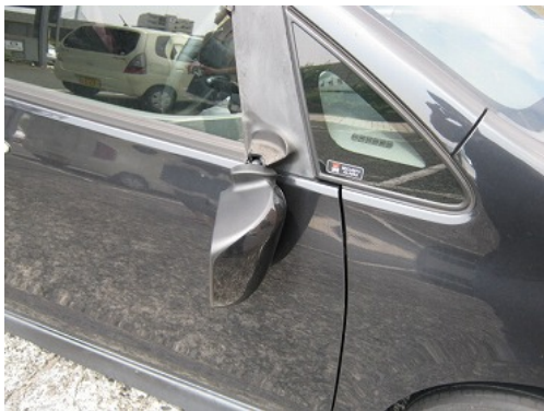
ドアミラーの格納忘れによる破損
