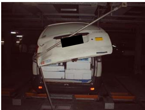
後部ドアの閉め忘れにより装置と接触し破損
