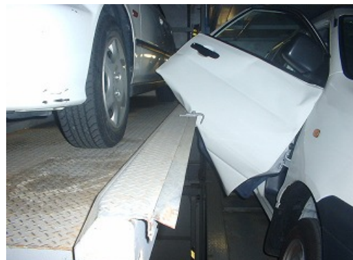
ドアの閉め忘れにより装置と接触し破損
